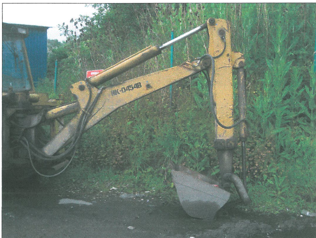
Fot. 4. Widok ramienia i łyżki koparki podsiębiernej koparko-ładowarki
