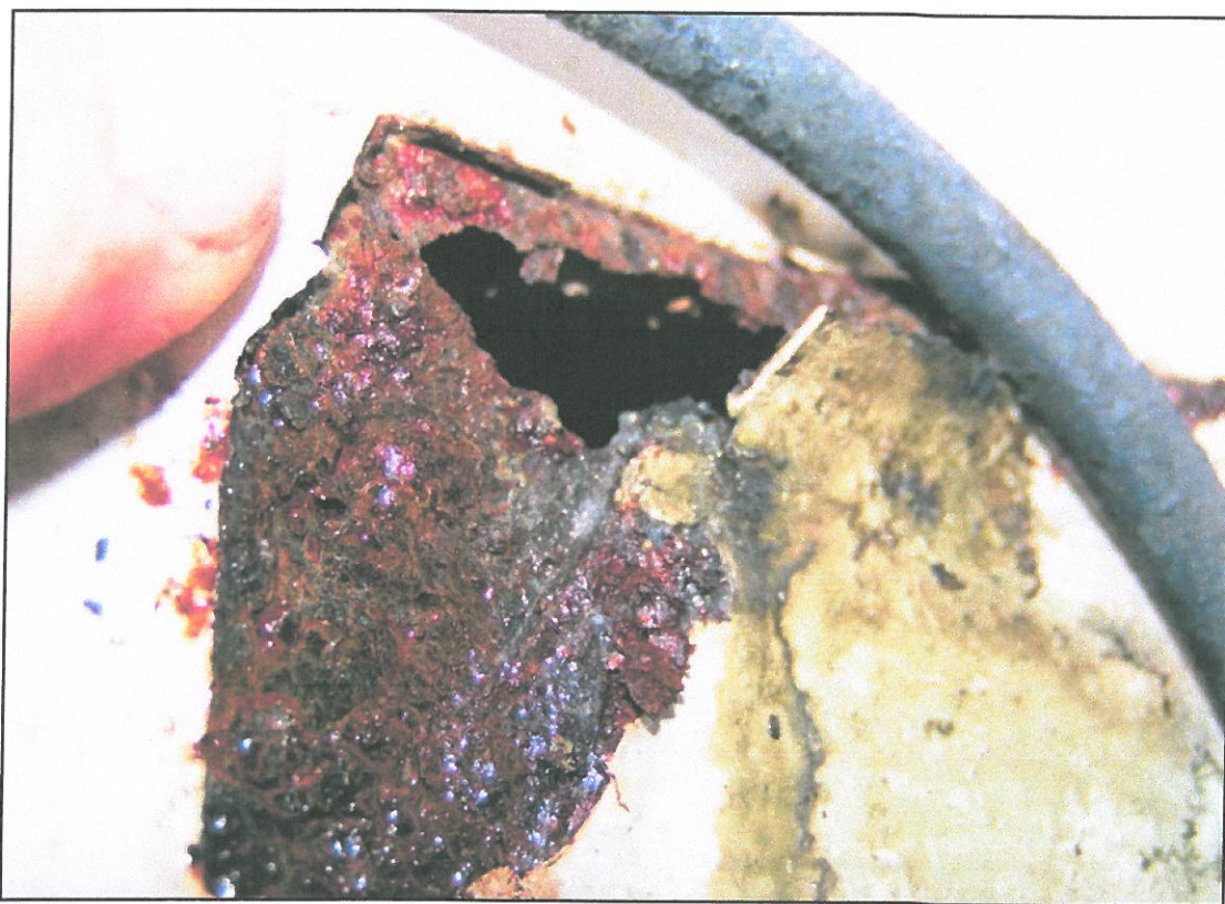
Rys. 10. Korozja na wskroś elementów ramy wsporczej
