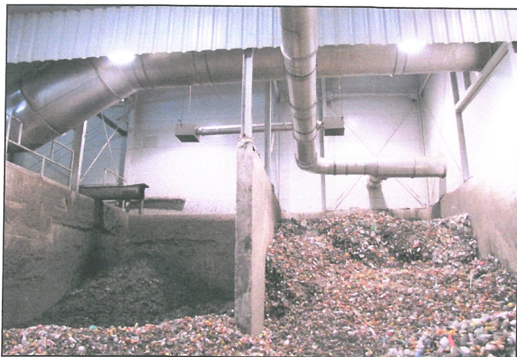
Rys. 4. Otwarte boksy do składowania odpadów na terenie hali 6d.3.
